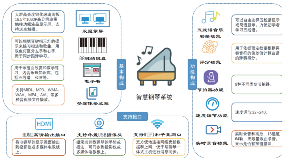
图3-34 智慧钢琴基本架构图
